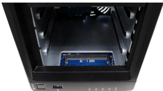
**Примечание.** После снятия лотков для дисков чувствительные внутренние компоненты остаются без защиты от внешних воздействий. Не трогайте внутренние компоненты, кроме блока памяти при его извлечении или установке.
