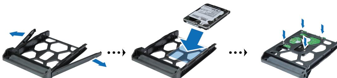
**4** Вставьте лоток с установленным диском в пустой отсек для дисков. Поверните диск стороной с отметкой **UP** кверху и вставьте его в отсек для дисков. Если лоток вставлен правильно, раздается щелчок.
